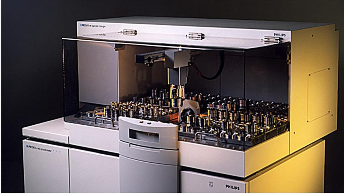
جهاز التحليل بالأشعة السينية الطيفية ماركة فيليبس موديل "PW 2404" مزود بحامل آلي للعينات حتى 168 عينة.
